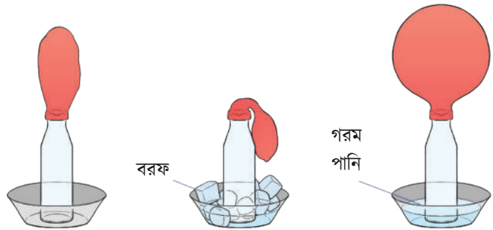
চিত্র ২.৫ : বেলনের ভেতরের বাতাস শীতল করা হলে বেলনটি সংকুচিত এবং উত্তপ্ত করা হলে প্রসারিত হয়।
